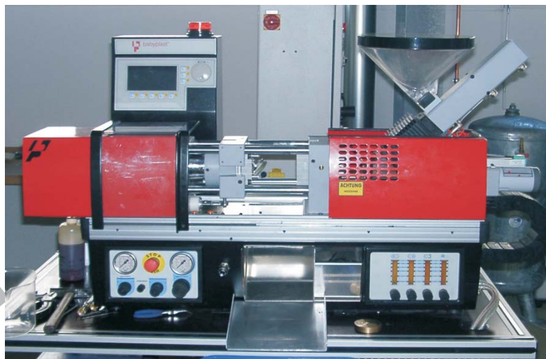
Spritzgießmaschine Babyplast, Spritzmasse bis ca. 5 g
