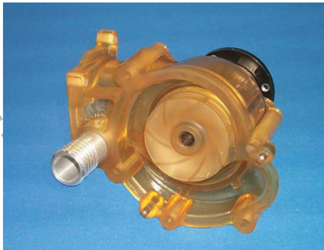
Wasserpumpe aus mehreren Stereolithographie- modellen montiert
