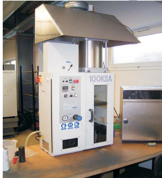
Laborspritzgießmaschine 100KSA, bis ca. 100 g
