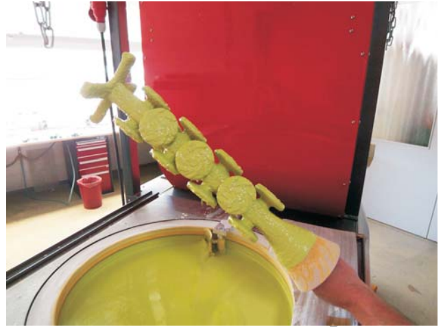
Schlickern Traube mit Feuchtigkeitsindikator
